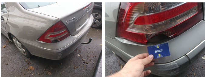
Licht LA - Licht LA - Gebarsten - Vervangen
