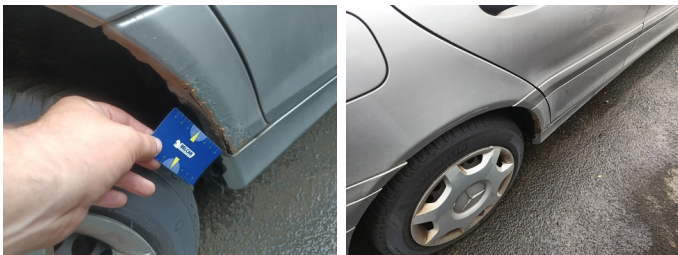
Vleugel RA - Vleugel RA - Corrosie / roest - Herstellen en spuiten
