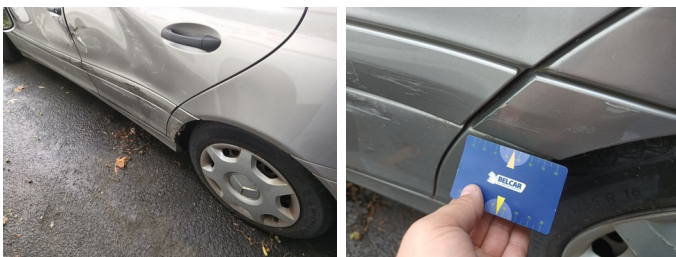
Vleugel LA - Sierlijst LA - Kras - Vervangen en spuiten
