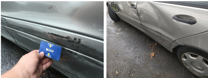
Deur LA - Stootlijst LA - Vervormd/geforceerd - Vervangen en spuiten
