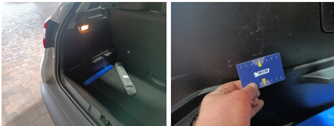
INT achteraan - Bekleding koffer L - Kras - Vervangen
