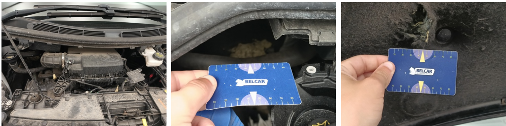
Motorkap - Isolatie - Scheur - Vervangen
