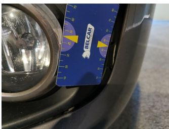
Bumper voor - Bumper rooster LV - Gebarsten - Vervangen
