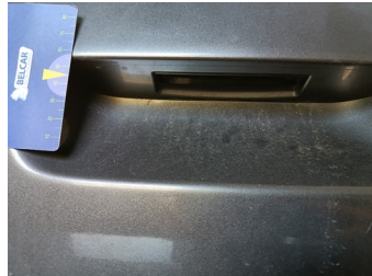
Koffer - Handvat LA - N comf / defect - Controleren
