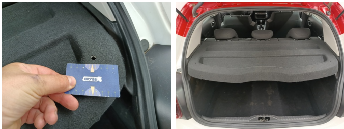
INT achteraan - Hoedenplank - N comf / defect - Vervangen
