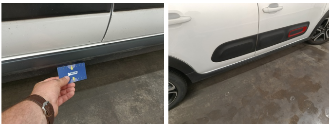
Onderkant R - Afdekking drempel R - Kras - Vervangen
