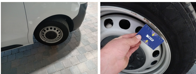
Wiel RV - Stalen velg RV - Kras - Vervangen
