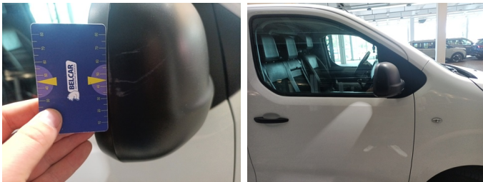
Spiegel R - Spiegelkap R niet-gespoten - Kras - Vervangen
