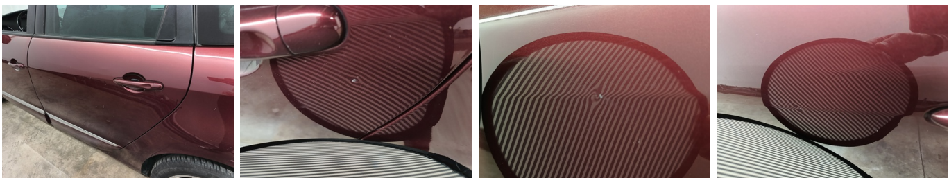
Deur LA - Deur LA - Kras en Deuk - Herstellen en spuiten
