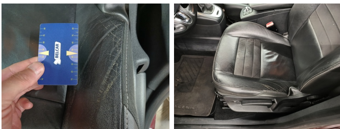
Zetels - Bekleding zit LV - Versleten - Vervangen
