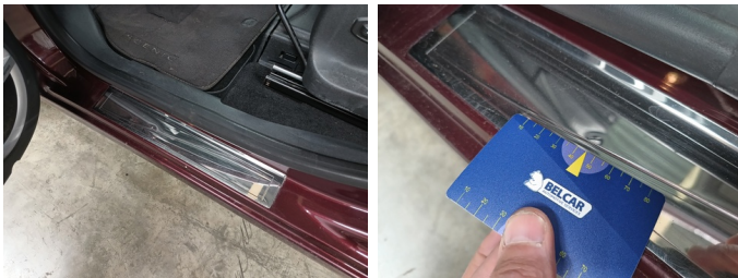
Onderkant L - Afdekking drempel L - Deuk - Vervangen
