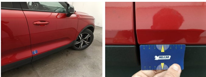
Deur RV - Deur RV - Slecht hersteld - Spuiten
