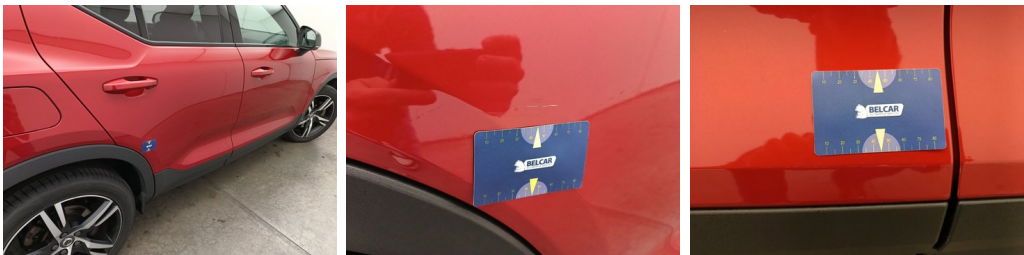
Deur RA - Deur RA - Slecht hersteld - Spuiten
