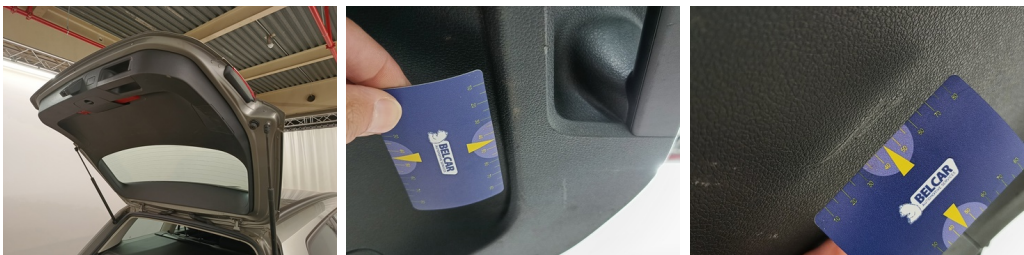
INT achteraan - Bekleding kofferdeksel - Kras - Vervangen
