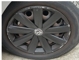
Wiel RV - Wieldeksel RV - Kras - Vervangen
