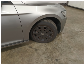
Wiel RV - Wieldeksel RV - Kras - Vervangen
