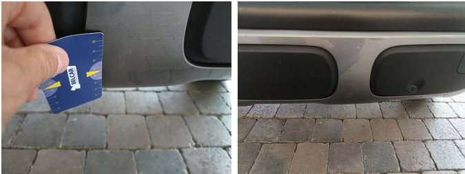
Bumper Achter - Spoiler bumper achter - Kras - Vervangen en spuiten
