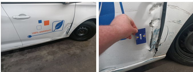
Deur RV - Deur RV - Vervormd/geforceerd - Vervangen en spuiten
