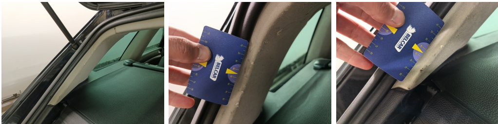
INT achteraan - Bekleding koffer L - Kras - Vervangen
