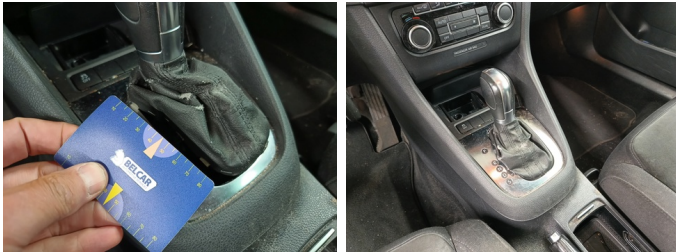
INT Vooraan / Midden - Afdekkap pook - Gebarsten - Vervangen
