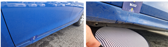
Onderkant L - Drempel L - Kras en Deuk - Vervangen en spuiten
