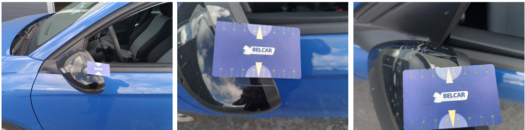
Spiegel L - Spiegelkap L gespoten - Gebarsten - Vervangen en spuiten
