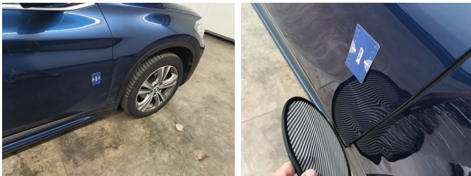
Deur RV - Deur RV - Kras en Deuk - Vervangen en spuiten
