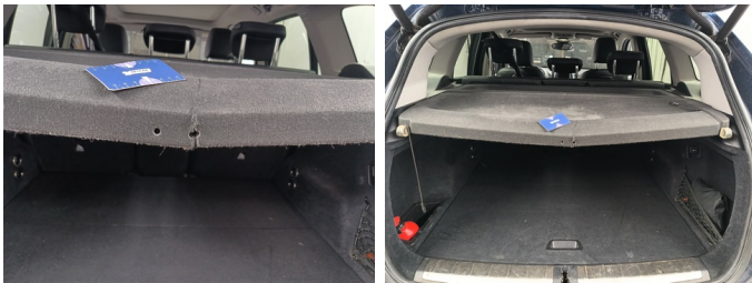
INT achteraan - Hoedenplank - Gebarsten - Vervangen
