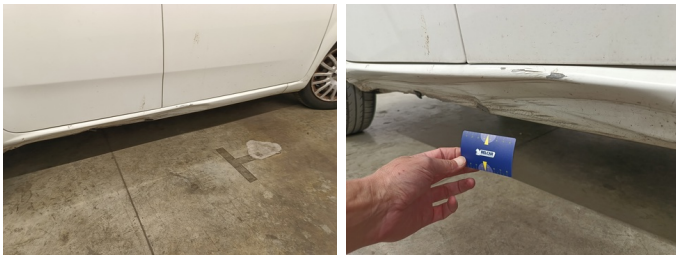
Onderkant R - Drempel R - Kras en Deuk - Vervangen en spuiten
