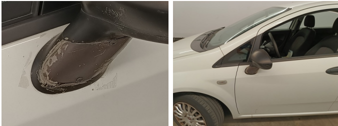
Spiegel L - Base L - Gebarsten - Vervangen
