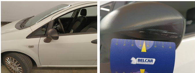
Spiegel L - Spiegelkap L niet-gespoten - Kras - Vervangen
