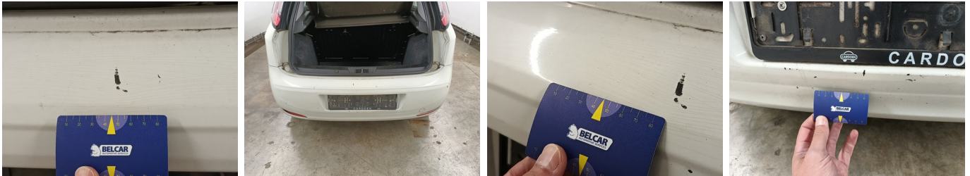
Bumper Achter - Bumper achter - Gebarsten - Vervangen en spuiten
