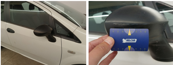
Spiegel R - Spiegelkap R niet-gespoten - Kras - Vervangen
