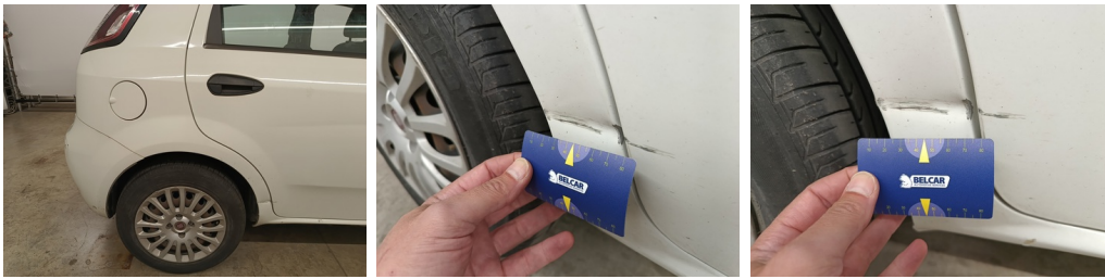
Deur RA - Deur RA - Kras en Deuk - Herstellen en spuiten
