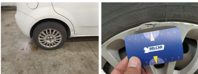
Wiel RA - Wieldeksel RA - Gebarsten - Vervangen
