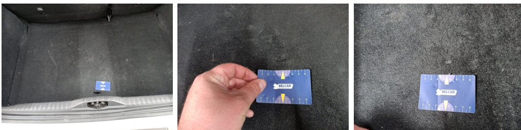
INT achteraan - Tapijt koffer - Versleten - Vervangen
