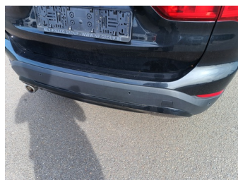
Bumper Achter - Spoiler bumper achter - Kras en Deuk - Vervangen en spuiten
