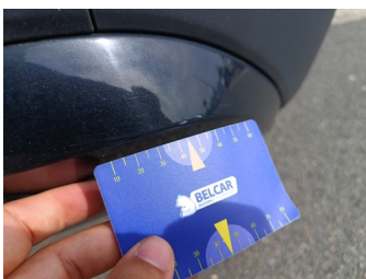
Bumper Achter - Spoiler bumper achter - Kras en Deuk - Vervangen en spuiten
