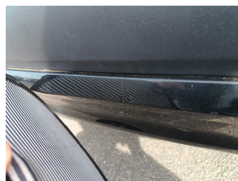
Bumper Achter - Spoiler bumper achter - Kras en Deuk - Vervangen en spuiten
