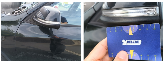
Spiegel L - Spiegelkap L niet-gespoten - Kras - Vervangen
