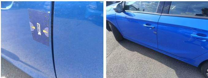
Deur LV - Deur LV - Kras - Touch-up
