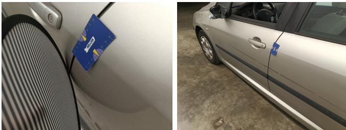
Deur LA - Deur LA - Kras en Deuk - Herstellen en spuiten
