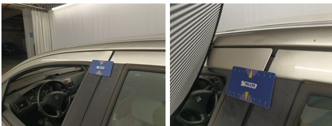
Deur LV - Deur LV - Deuk - Herstellen en spuiten
