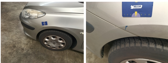
Vleugel LV - Vleugel LV - Kras - Spotrepair
