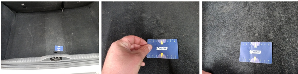
INT achteraan - Tapijt koffer - Versleten - Vervangen
