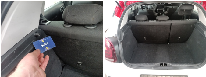
INT achteraan - Hoedenplank - Ontbreekt - Vervangen
