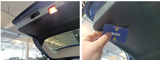
INT achteraan - Bekleding kofferdeksel - Kras - Vervangen
