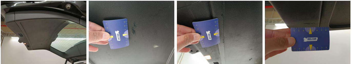
INT achteraan - Bekleding kofferdeksel - Kras - Structuur
