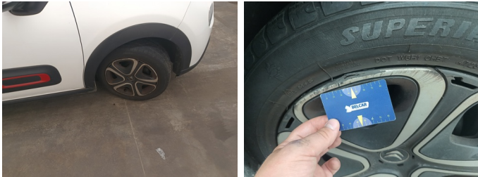
Wiel RV - Wieldeksel RV - Gebarsten - Vervangen
