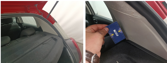
INT achteraan - Bekleding koffer R - Kras - Vervangen
