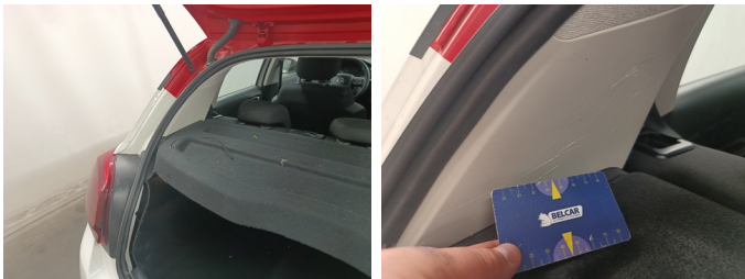
INT achteraan - Bekleding koffer L - Kras - Vervangen
