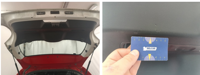
INT achteraan - Bekleding kofferdeksel - Kras - Vervangen
