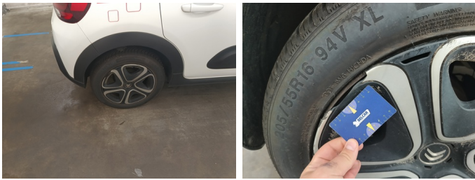
Wiel RV - Wieldeksel RV - Gebarsten - Vervangen
