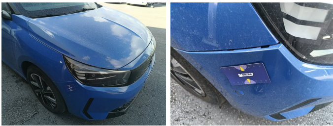
Bumper voor - Bumper vooraan - Slecht geplaatst - Herstellen
