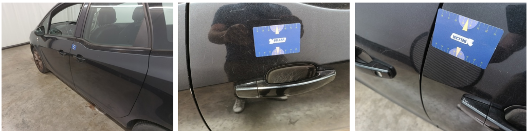
Deur LA - Deur LA - Kras en Deuk - Herstellen en spuiten
