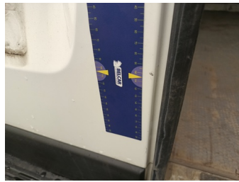
INT achteraan - Bekleding laadruimte - Kras - Vervangen
