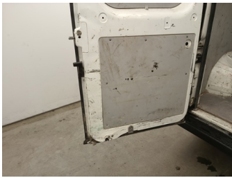
INT achteraan - Bekleding laadruimte - Kras - Vervangen
