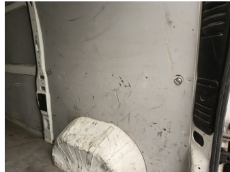
INT achteraan - Bekleding laadruimte - Kras - Vervangen
