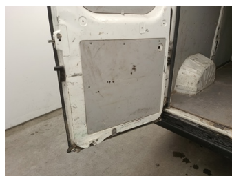
INT achteraan - Bekleding kofferdeksel - Kras - Vervangen
