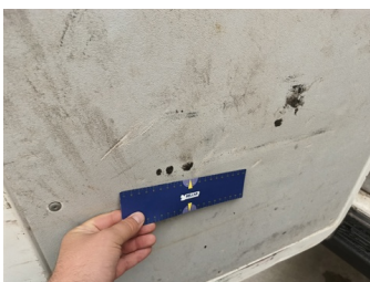
INT achteraan - Bekleding kofferdeksel - Kras - Vervangen
