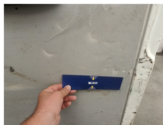
Bumper Achter - onderste bekleding ongespoten achter - Kras - Vervangen
