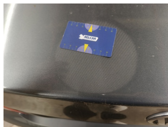
Koffer - Kofferdeksel - Hagelschade - PDR
