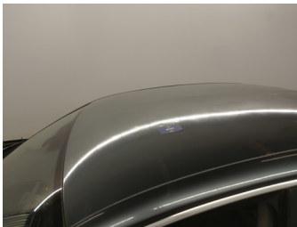
Boven - Dak - Hagelschade - PDR
