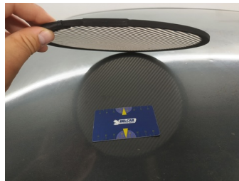
Koffer - Kofferdeksel - Hagelschade - PDR
