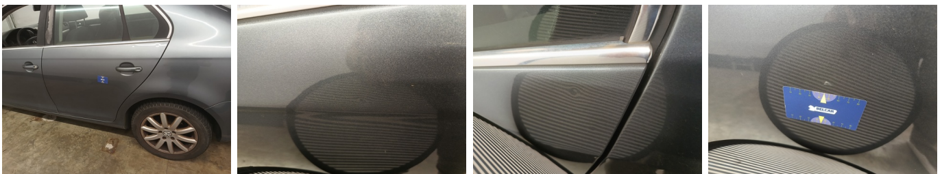
Deur LA - Deur LA - Kras en Deuk - Herstellen en spuiten
