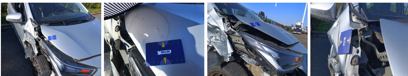
Motorkap - Motorkap - Kras en Deuk - Vervangen en spuiten
