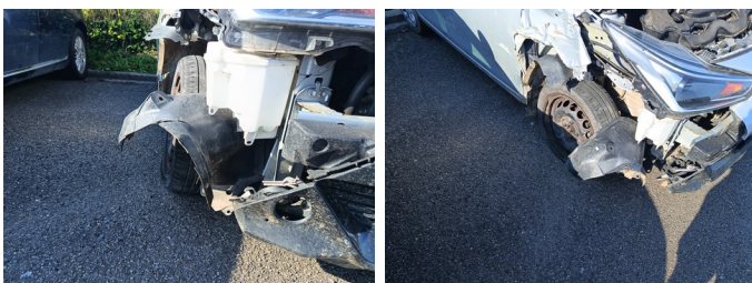
Wiel RV - Stalen velg RV - Vervormd/geforceerd - Vervangen
