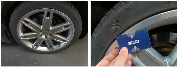
Wiel LA - Band LA - Scheur - Vervangen
