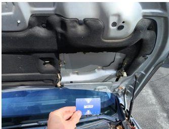
Motorkap - Isolatie - Scheur - Vervangen
