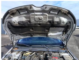
Motorkap - Isolatie - Scheur - Vervangen
