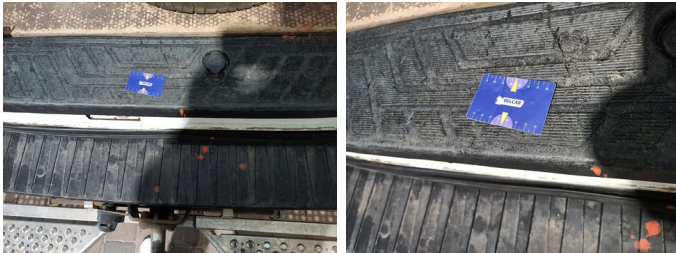
INT achteraan - Bekleding laadruimte - Kras - Vervangen
