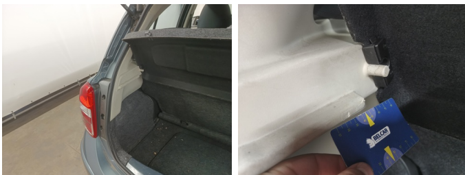
INT achteraan - Bekleding koffer L - Kras - Vervangen
