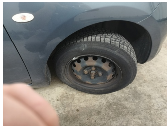
Wiel RV - Stalen velg RV - Vervormd/geforceerd - Vervangen
