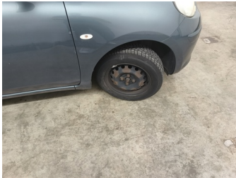
Wiel RV - Wieldeksel RV - Ontbreekt - Vervangen
