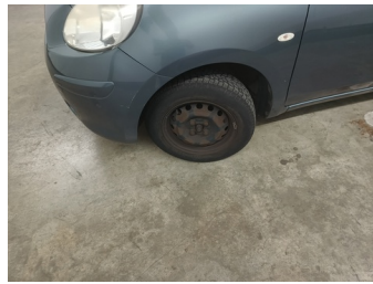
Wiel LV - Stalen velg LV - Vervormd/geforceerd - Vervangen
