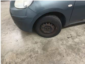
Wiel LV - Stalen velg LV - Vervormd/geforceerd - Vervangen
