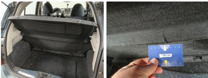
INT achteraan - Hoedenplank - Gebarsten - Vervangen
