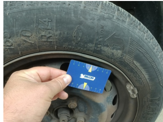
Wiel LV - Stalen velg LV - Vervormd/geforceerd - Vervangen
