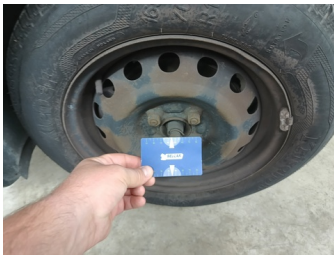
Wiel LV - Stalen velg LV - Vervormd/geforceerd - Vervangen
