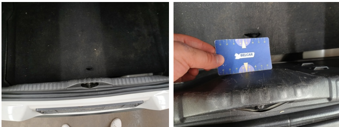
INT achteraan - Bekleding laadruimte - Kras - Vervangen
