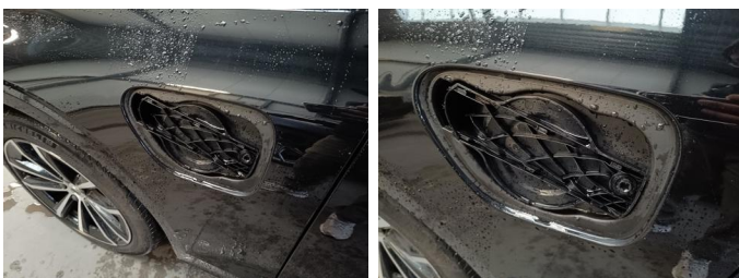
Vleugel LV - Laadklep LV - Ontbreekt - Vervangen en spuiten
