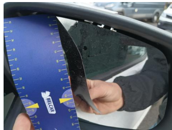
Spiegel R - Spiegelglas R - Gebarsten - Vervangen
