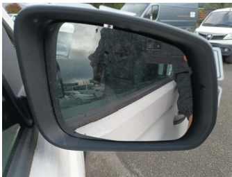
Spiegel R - Spiegelglas R - Gebarsten - Vervangen
