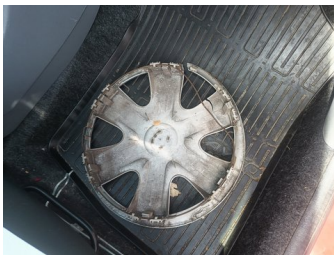
Wiel LA - Wieldeksel LA - Vervormd/geforceerd - Vervangen
