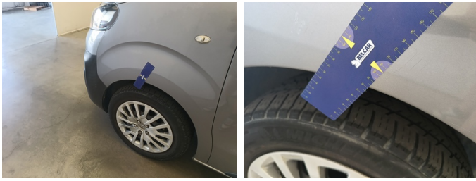
Vleugel LV - Vleugel LV - Kras - Spotrepair
