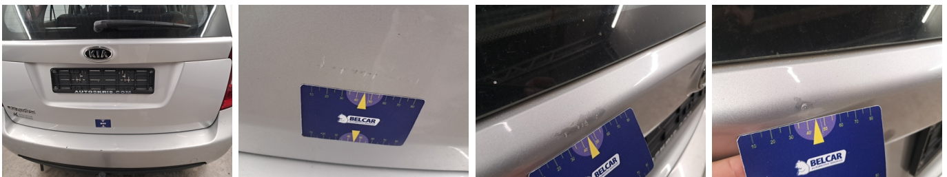
Koffer - Kofferdeksel - Slecht hersteld - Spuiten
