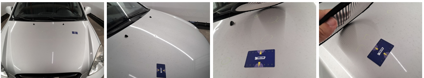
Motorkap - Motorkap - Hagelschade - Herstellen en spuiten
