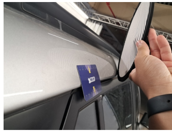
Boven - Dak - Hagelschade - Herstellen en spuiten
