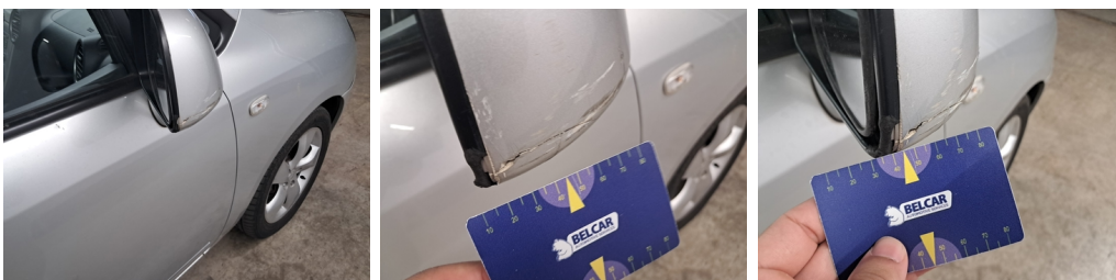
Spiegel R - Spiegel R compleet - Gebarsten - Vervangen en spuiten
