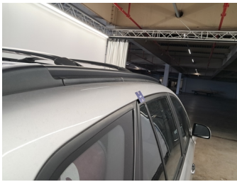
Boven - Dak - Hagelschade - Herstellen en spuiten
