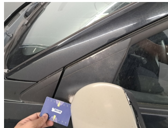
Spiegel L - Spiegel L compleet - Gebarsten - Vervangen en spuiten
