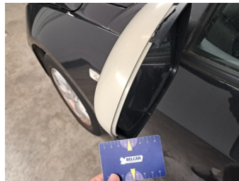
Spiegel L - Spiegel L compleet - Gebarsten - Vervangen en spuiten
