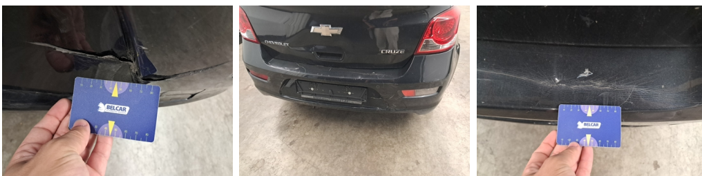
Bumper Achter - Bumper achter - Gebarsten - Vervangen en spuiten
