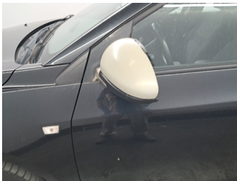
Spiegel L - Spiegel L compleet - Gebarsten - Vervangen en spuiten
