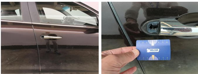
Deur RV - Deurklink RV - N comf / defect - Vervangen
