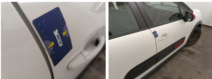
Deur RV - Deur RV - Kras - Touch-up
