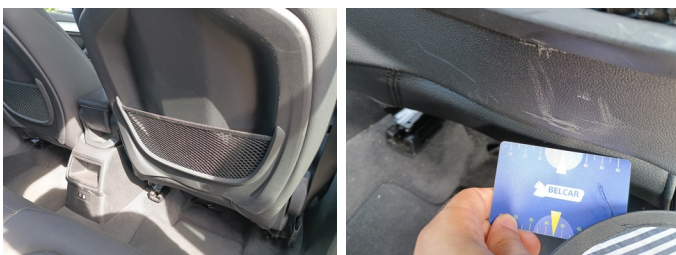
Zetels - Bekleding rug RV - Kras - Vervangen
