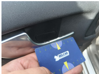
INT Vooraan / Midden - Deurklink INT LV - Vervormd/geforceerd - Vervangen
