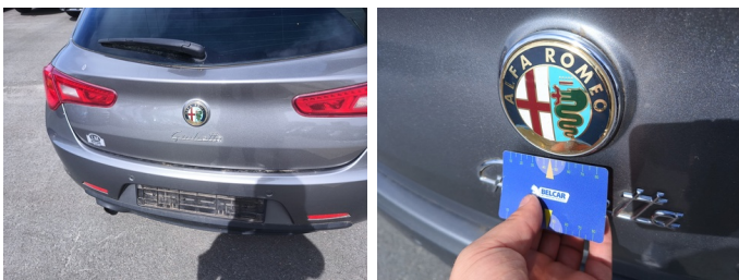
Koffer - Embleem achter - Gebarsten - Vervangen
