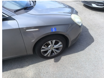
Vleugel RV - Vleugel RV - Vervormd/geforceerd - Herstellen en spuiten
