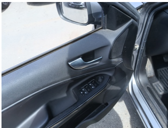
INT Vooraan / Midden - Deurklink INT LV - Vervormd/geforceerd - Vervangen
