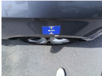
Vleugel RV - Vleugel RV - Vervormd/geforceerd - Herstellen en spuiten
