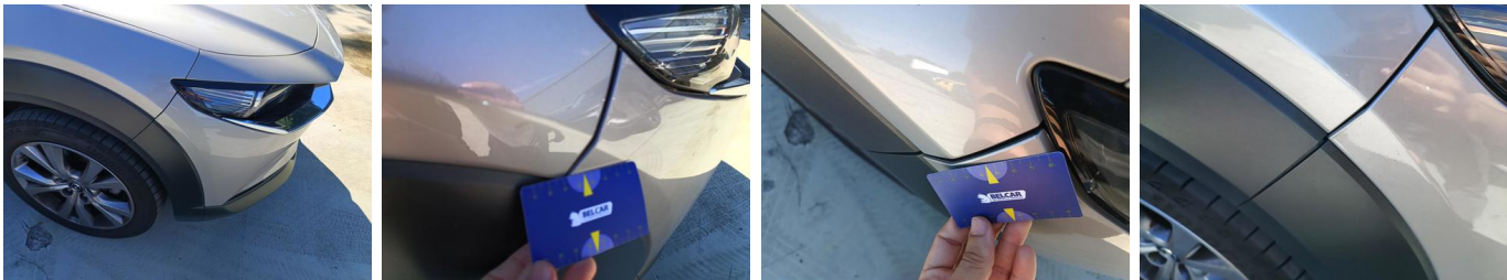
Bumper voor - Bumper vooraan - Slecht geplaatst - Herstellen
