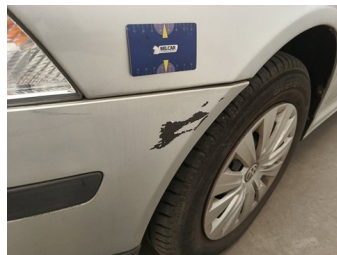
Bumper voor - Bumper vooraan - Gebarsten - Vervangen en spuiten
