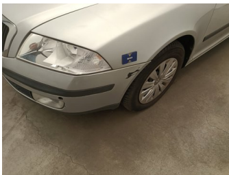
Bumper voor - Bumper vooraan - Gebarsten - Vervangen en spuiten
