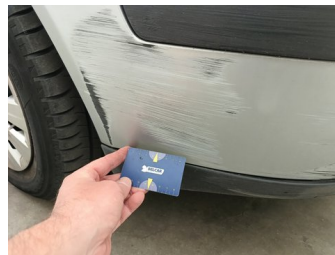
Bumper voor - Bumper vooraan - Gebarsten - Vervangen en spuiten
