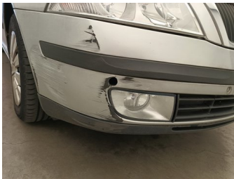
Bumper voor - parkeersensor vooraan - Ontbreekt - Vervangen
