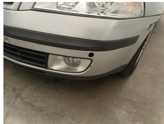
Bumper voor - parkeersensor vooraan - Ontbreekt - Vervangen
