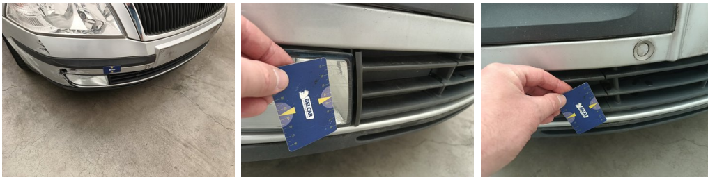
Bumper voor - Bumper rooster LV - Slecht geplaatst - Vervangen
