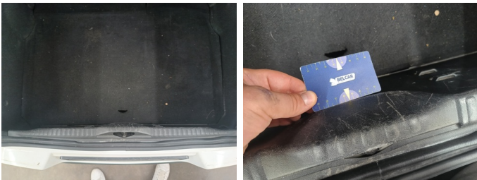
INT achteraan - Bekleding laadruimte - Kras - Vervangen
