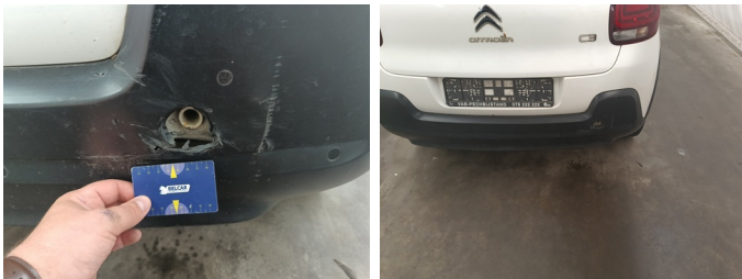
Bumper Achter - onderste bekleding ongespoten achter - Gebarsten - Vervangen
