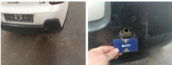
Bumper Achter - Afdekkap bumper achter - Ontbreekt - Vervangen
