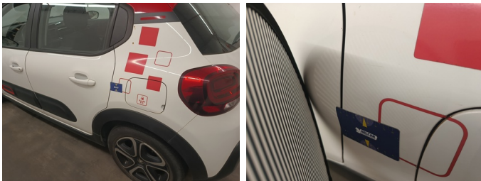
Bumper Achter - onderste bekleding ongespoten achter - Gebarsten - Vervangen
