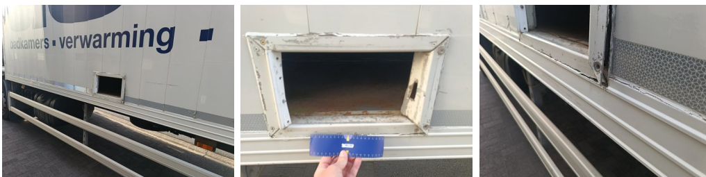
Extra - Herstelling exterieur 2 - Ontbreekt - Vervangen
