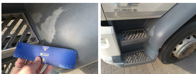
Vleugel LV - Sierlijst LV - Kras - Vervangen
