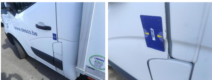
Deur LV - Deur LV - Kras - Touch-up
