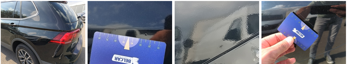
Vleugel LA - Vleugel LA - Slecht hersteld - Herstellen en spuiten
