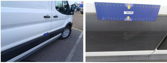
Deur RA - Stootlijst RR - Kras - Vervangen
